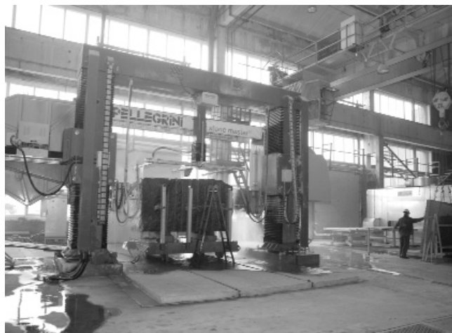
Рис. 1. Алмазно-канатная распиловочная машина на производстве ООО "АКАМ"
