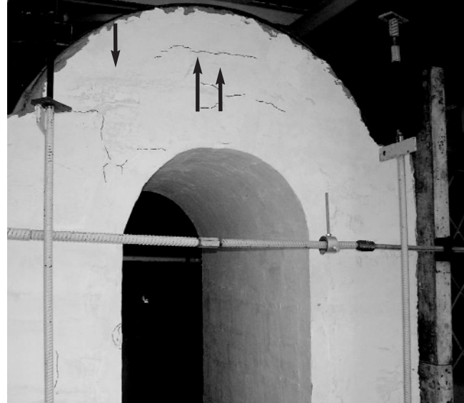
Рис. 8. Характер деформацій отриманий під час другого етапу випробувань
